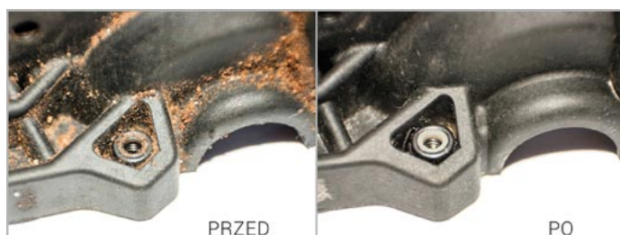
Zbliżenie na plastikową obudowę dyferencjału
